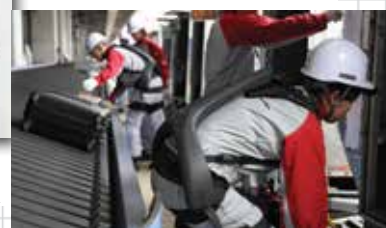
外骨骼輔助套裝可減省工作人員的體力，更安全地提取重物。
